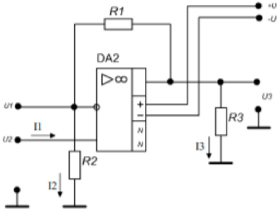
Рис. 2 - Схема неинвертирующего ОУ
