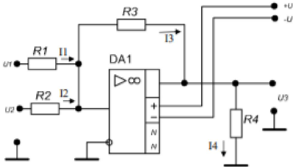
Рис. 1 Схема сумматора на ОУ
